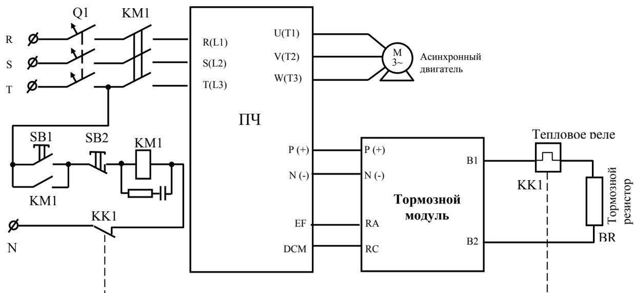
1. Тепловое реле КК1 устанавливается в целях безопасности для предотвращения перегрева и разрушения тормозного резистора вследствие длительных перегрузок по току.
