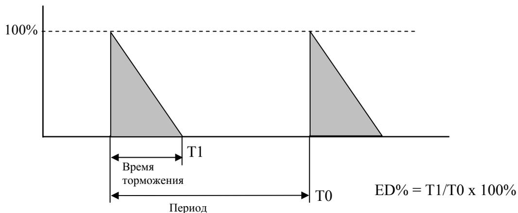
Допустимый коэффициент использования ED% применяется для оценки времени необходимого для рассеяния мощности, выделяемой в тормозном резисторе и модуле. Если тормозной резистор будет перегреваться, то будет увеличиваться его сопротивление и, следовательно, тормозной момент будет уменьшаться.
